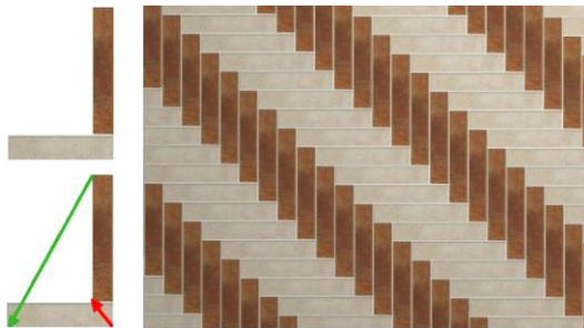
Rys. 461 – tworzenie układu płytek w „jodełkę”
